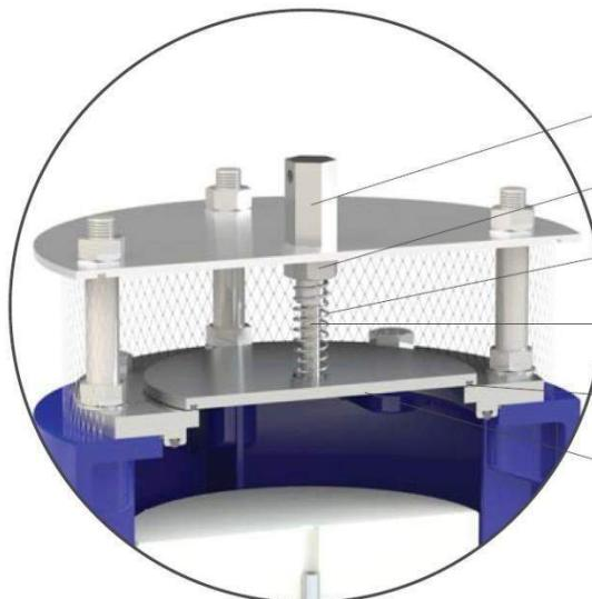
Направляющая гайка из нерж.стали
